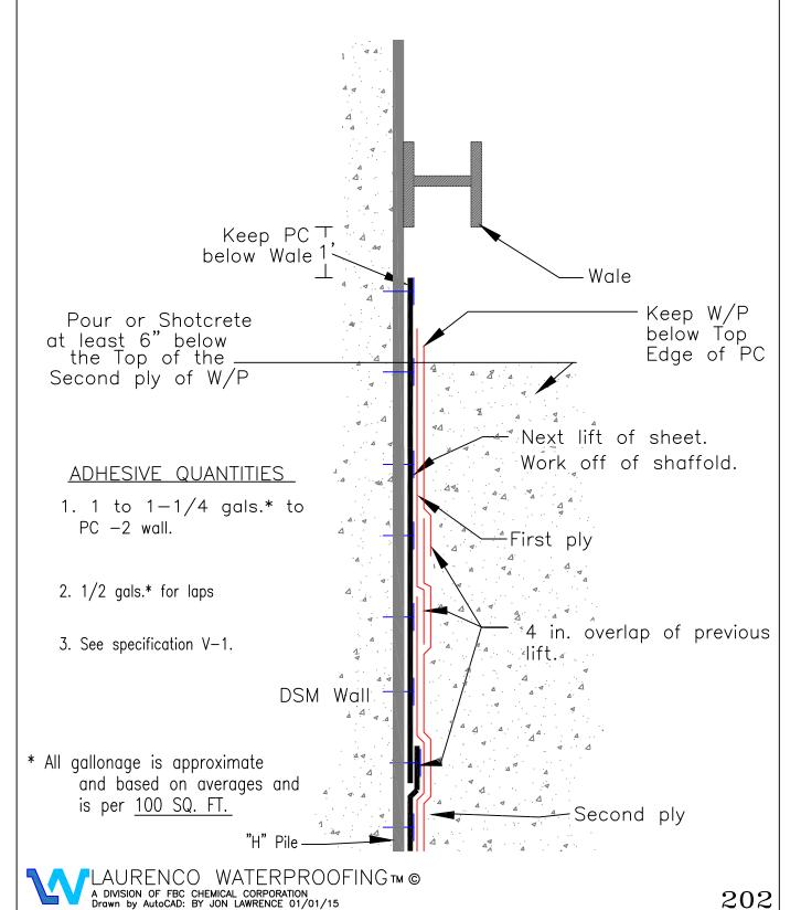
2 PLY WALL APPLICATION OVER MECHANICALLY ATTACHED PC-2
